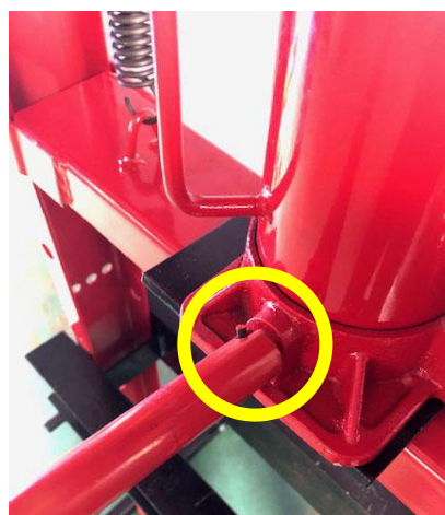
ハンドルの切れ込み部分 にはめ込み回転させる
