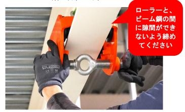
トロリーが外れない事を確認し、留め具で ロードバーを固定したら取付け完了です。
