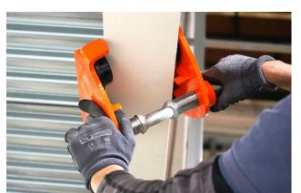
ロードバーを回して反対側のローラーも ビーム鋼へ合わせる。
