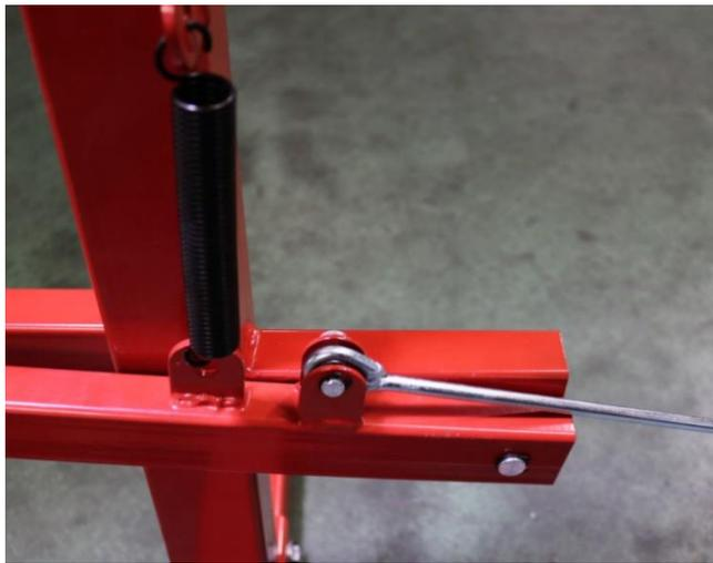
④フットペダル組・⑤ペダル止めピン・⑥バネを使い図のように組立ています。
