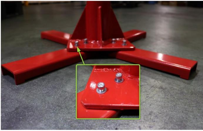
①と③と④を図のように組み立てます。※必ず平らな所で組立てください。
