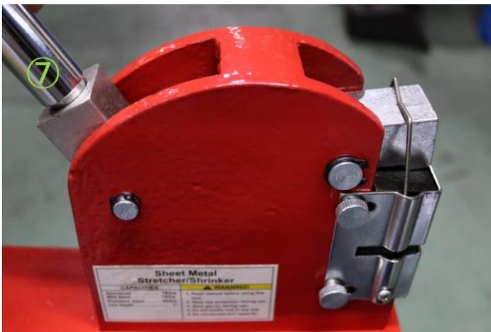
⑦のハンドルを差し込みネジで作動部についている六角穴付き止めネジを締めます。
