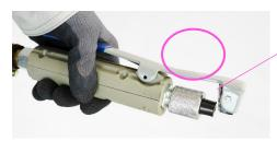
ブラストガン先端ネジを外し、使用目的に合わせて先端 ノズルを入れ替えてご使用ください。
