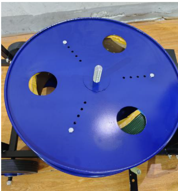
4-7. ディスク中央穴と ネジ棒位置を合わせます。
