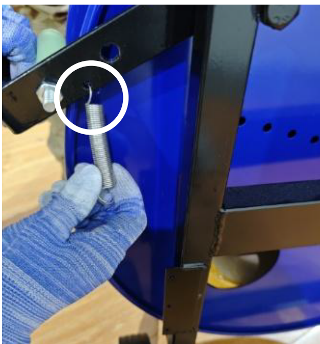
4-9. スプリングの片側を 上部穴に掛けます。
