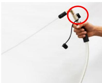
2. 適切なオイル抜き取りチューブをプローブに取付けます。
