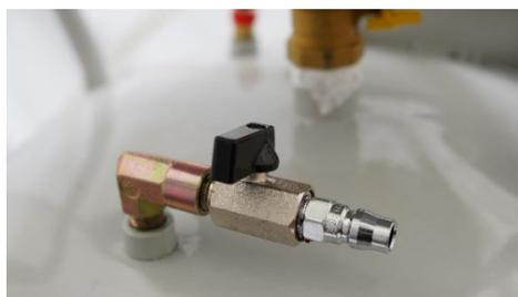
4. 下タンクにエアーを接続してバルブを少しだけ開きます。タンクにエアーが入り廃油がホースより排出されます。排出される勢いと量を確認しながらエアーバルブを調整してください。
