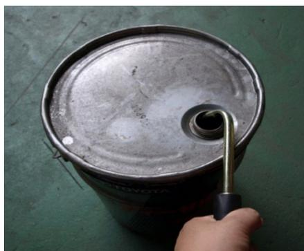
2. 廃油を移すタンクに廃油排出プローブをセットします。
