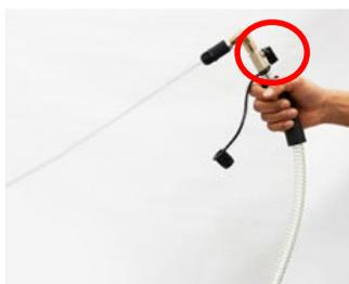
1. 透明オイルタンク下のバルブ／下抜き用スライドパイプ用バルブ／下タンクエアー接続口バルブ／プローブバルブの全てのバルブを閉じてください。
