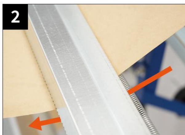
ロール端をカッターの(Spring)に通して切る
