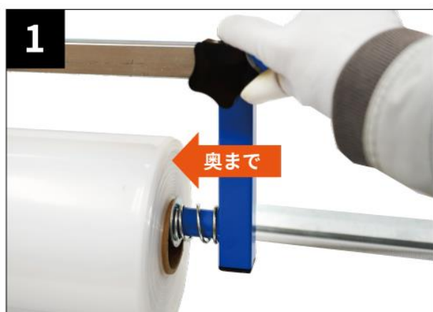
ホルダーにロールを差し込み、ノブで固定する
