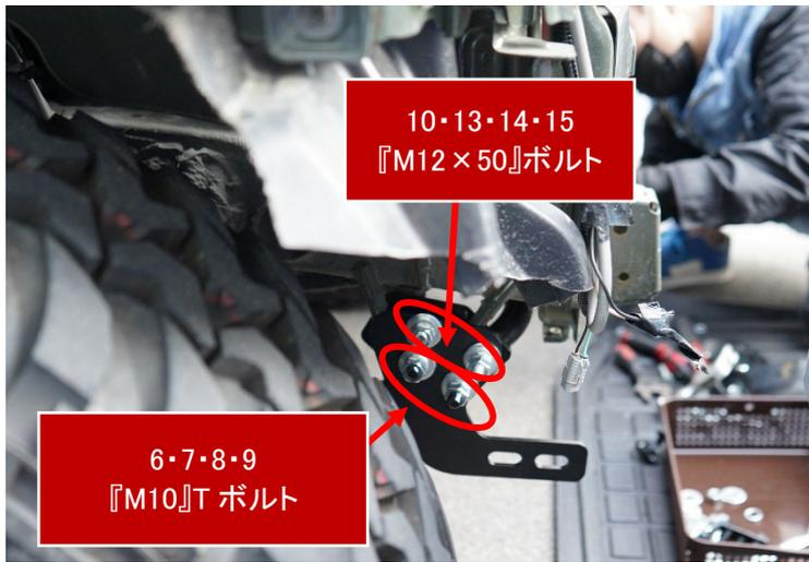
マウントブラケット C とマウントブラケット D を、運転席側(向かって左側)のタイダウンフックを挟み込むようにして取り付ける。
