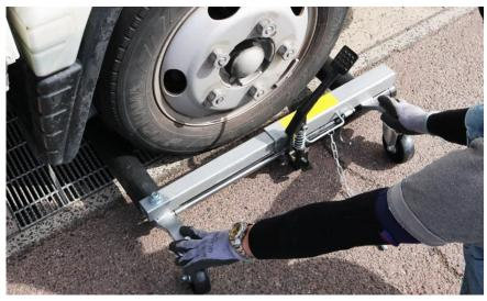
②次にタイヤ受け部を手で広げ、タイヤを両脇から挟みます。この時タイヤ受け部の中央にタイヤがくるよう設置して下さい。
