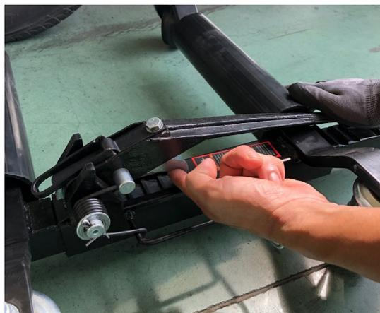
① 足踏みペダルで下降させたらハンドル下にある爪 (大) を持ち上げながら足踏みペダルを下に抑える
