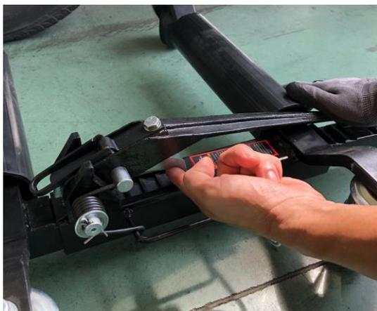
① 足踏みペダルで下降させたら下にある爪 (大) を持ち上げながら足踏みペダルを下に抑える
