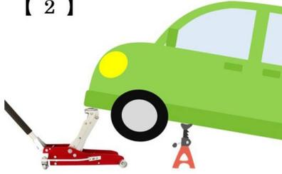
ジャッキアップ後、ジャッキスタンドをジャッキポイントの高さに合わせて置きます。
