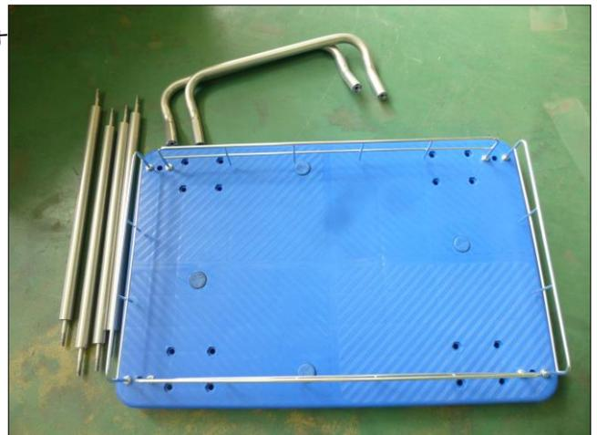
支柱を上段プレート裏から挿し込み、ハンドルのネジ穴に固定します。
