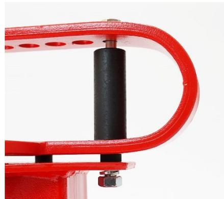
1. (6)リング止め用スペーサー(内径 10.5mm)と(13)スペーサー(小)を図のように置き、(15)取り付け用ボルト(ロング)M10×110mmと(14)平ワッシャー(15)スプリングワッシャー(16)ナットで固定します。
