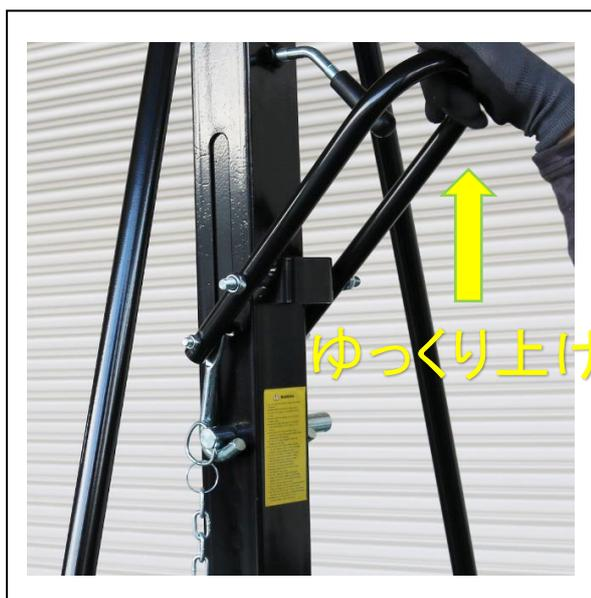
1. 固定ピン(③)をハンドル下の穴に挿し込む。(ピンが既に挿し込まれている場合はそのままよい)
