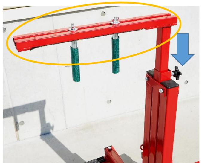
左記で組立てた支柱に、サポートバー（上側）を挿しこみ取付ける。(挿しこむだけです)
