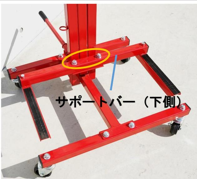
支柱にサポートバー（下側）を取付ける。
