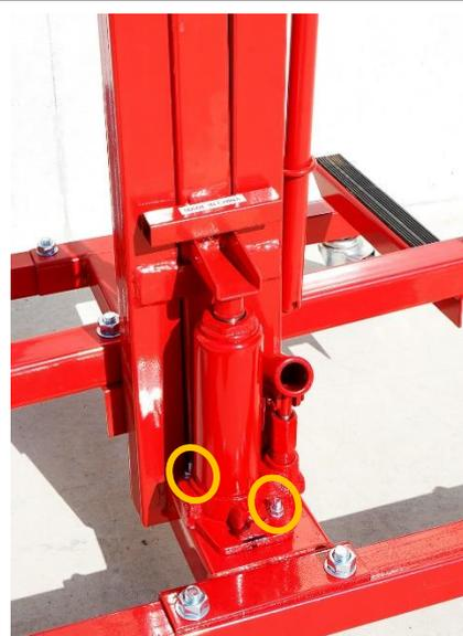
背面に油圧ジャッキを取付ける。(計2ヵ所固定)
