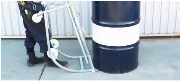
**STEP 02** 運搬車を垂直にドラム缶にそわせ、上の引っ掛けを缶のフチにかけます
