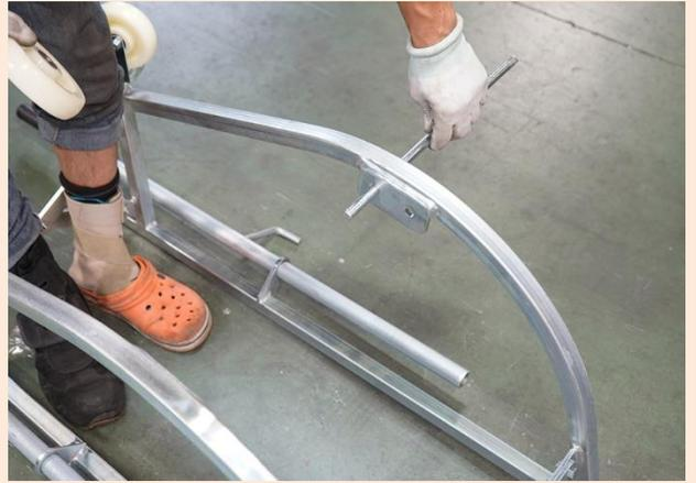
ワッシャー・車輪・ワッシャー の順で取り付け、割りピンで固定します
