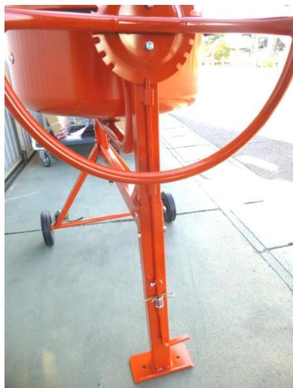
ストッパー用部品 2 個を組み合わせ、画像を参照して取り付けてください
