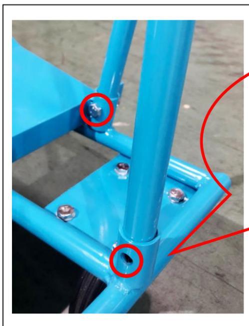
パイプの取り付け穴を合わせる
