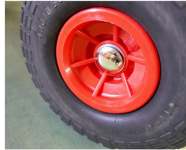
アスクルにタイヤを差し込み、キャップを手のひらで押し込むようにはめて下さい。
