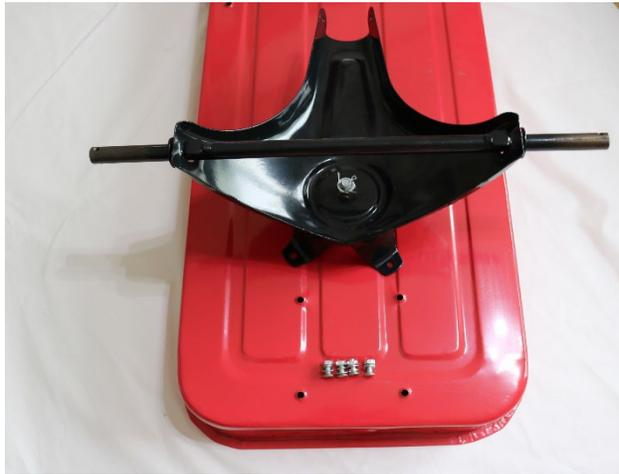
⑬皿ビスセットでフロントアスクル部を取り付けます。
