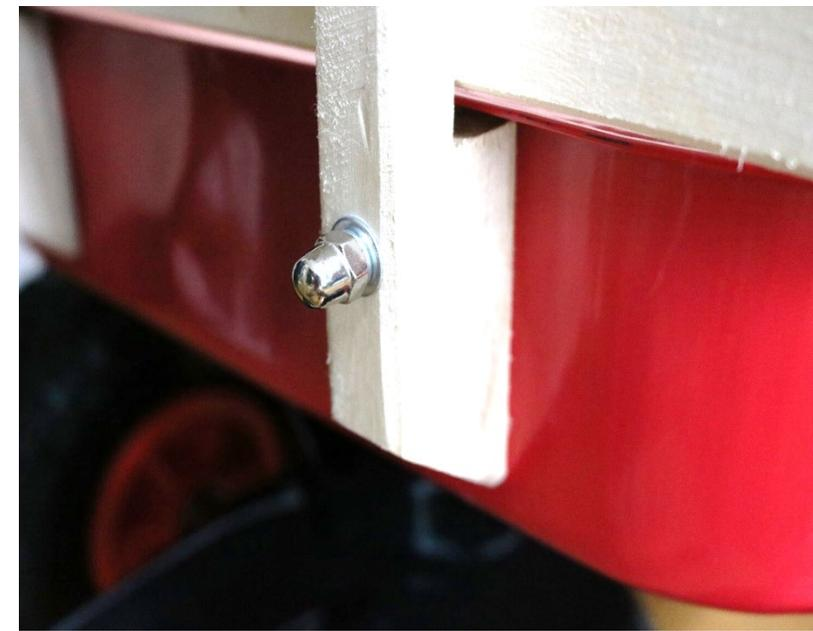
図のように袋ナットが本体外側になるように取り付けて下さい。
