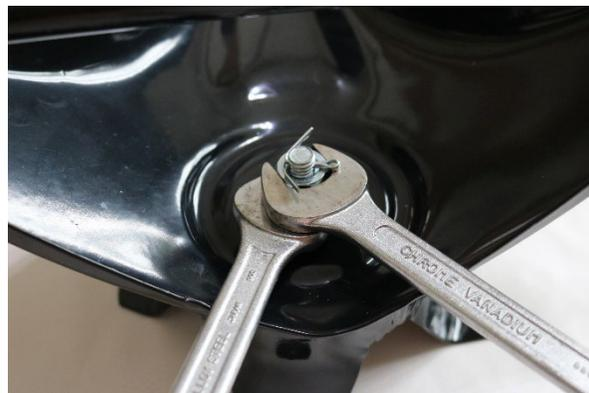
スパナを使い割ピン側に押しあてるように下側のナットと上側のナットをきつく締め込みます(ダブルナットと言う技法です)
