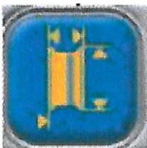
ホイールサイズ位置表示LED (J) のリム幅部分が点灯します、これはリム幅 5.5 インチを意味します、プラス/マイナスキーを操作して取付けたホイールのリム幅に合わせます
