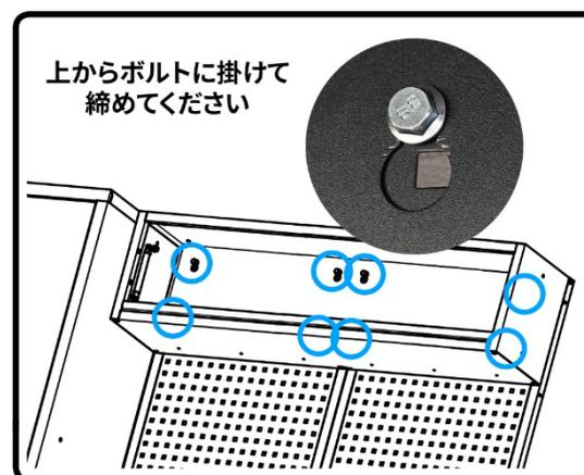
⑧キャビネットの引出しを元に戻し、ボルトを全て増し締めします。
