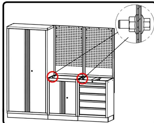
⑥連結金具同士を【ボルト(M6×16)】と【ナット(M6)】で連結する。
