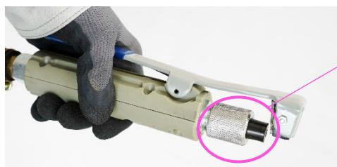
ブラストガン先端ネジを外し、使用目的に合わせて先端ノズルを入れ替えてご使用ください。
