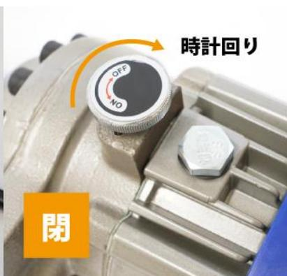
3. プラグを電源に挿し込み、油圧バルブを時計回り(閉)に回します。
