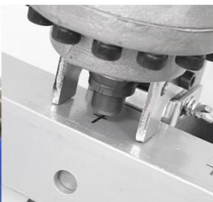
2. 油圧バルブを反時計回り(開)に回し、穴あけする位置を確認して、切断物を水平に置きます。
