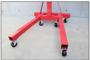
※脚の固定はボルトで押さえつけるだけになります。 ボルトをしっかりと締めて、きちんと固定できているかを必ずご確認ください。
