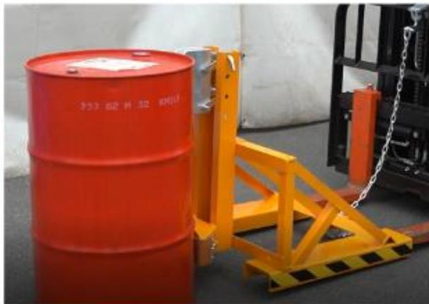
**1** フォークリフトのマストを少し前傾させ、ドラムキャッチャーの爪をドラム缶の縁より少し低くします
